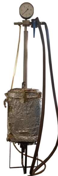
Rysunek 5. Prototyp reaktora ciśnieniowego do toryfikacji, a) reaktor bez dodatkowej izolacji z wełny mineralnej, b) reaktor z dodatkową izolacją. 1 – rura wylotowa, 2 – zawór górny, 3 – zawór bezpieczeństwa, 4 – manometr, 5 – chłodnica, 6 – komora reaktora owinięta matą grzewczą i taśmą izolacyjną z włókna szklanego, 7 – zawór dolny [14]
