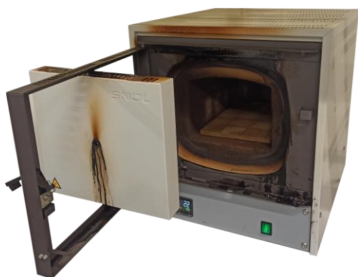
Rysunek 3. a) Piec muflowy (Snol, 8.1/1100, Utena, Litwa) b) Przykładowy przebieg temperatury podczas toryfikacji osadów ściekowych i pofermentu, warunki procesu 300 °C i 60 min, publikacja [17]
